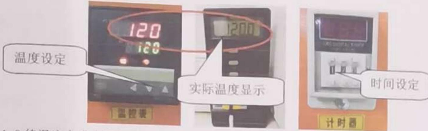
6.3.1.3 待温度上升实际温度达到烘烤标准后, 戴上隔热保护手套, 将烤箱门打开, 将需要烘烤的FPC用铝盘装好(每个机种放置一个铝盘, 不可混装, 产品放置板子不得超过铝盘边缘, 放置高度不得超出铝盘深度), 放入烤箱内打开计时开关进行烘烤并做好烘烤记录。
