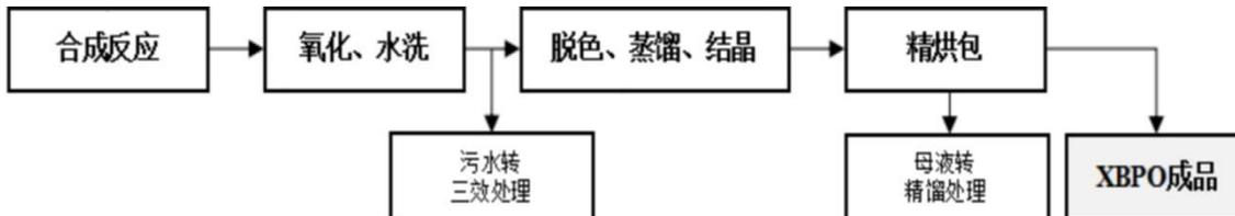
XBPO 产品生产线工艺流程图
