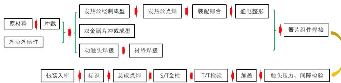
杭州星帅尔电器股份有限公司 QL2系列起动器生产流程图
