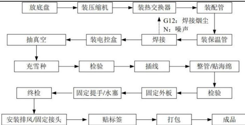
现场看到，车间内流水线生产，生产设备自动化程度较高，流水线生产工艺与介绍的一致。现场观察，车间内有外机产线7条、水塔和中央空调。生产过程用能主要是生产线设备、车间照明设施、空调、产线安全监控设备等运转消耗电力，产线中涉及焊接的工序，使用天然气和氧气配合燃烧解热熔化铜管，进行焊接。冷却工序使用循环水。
