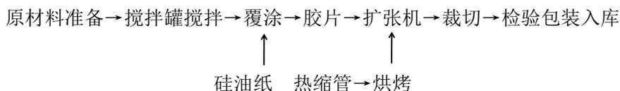
（3）高分子聚氨酯原料生产工艺流程：
