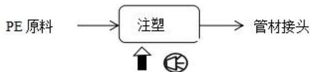
图 5-2 二期工程管材接头生产工艺流程及产污节点图
