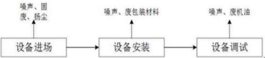
图 5-1 施工期工艺流程及产污工序图
