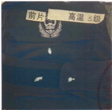
图九：高温条件下防弹衣 (4号前片) 正面弹伤图
