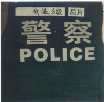
图十五：低温条件下防弹衣 (5号后片)正面弹伤图
