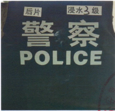
图七：浸水条件下防弹衣 (3号后片) 正面弹伤图
