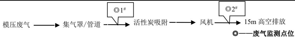
图 3-1 模压废气处理工艺流程图
