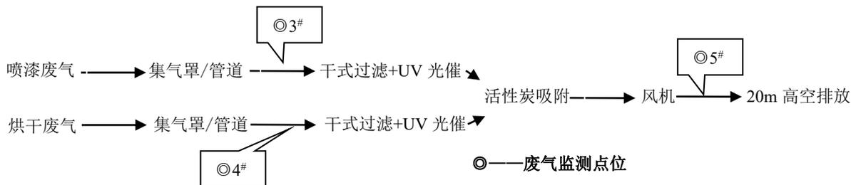
图 3-2 涂装废气处理工艺流程图
