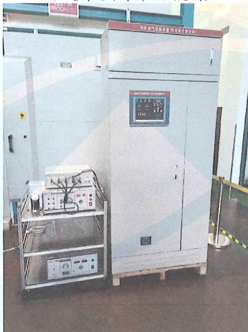
电快速瞬变脉冲群抗扰度试验
