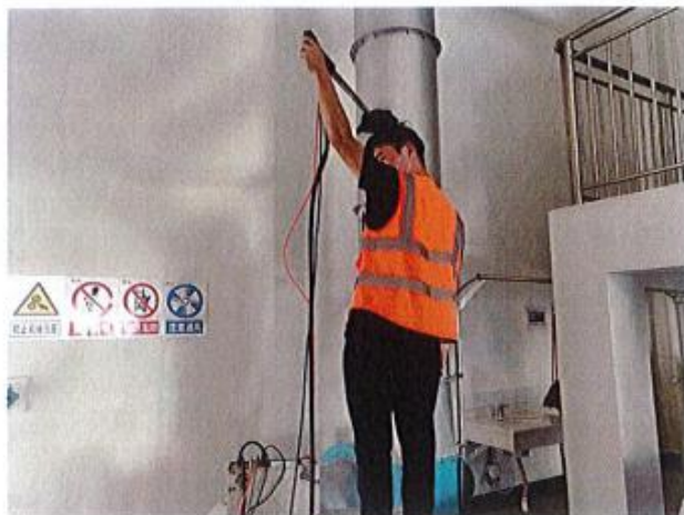
麦芽去石粉尘出口◎5#有组织排放废气检测点位
