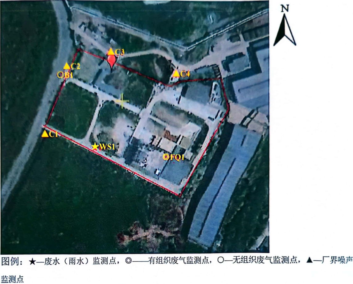
图 1 废水（雨水）、有组织废气、无组织废气和厂界噪声监测布点示意图
