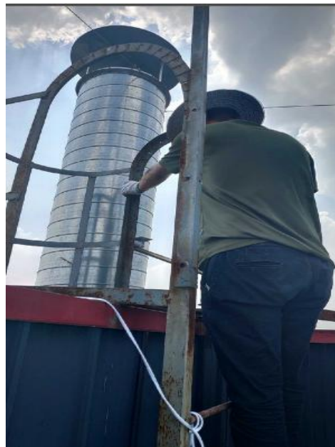
有机废气排气筒采样
