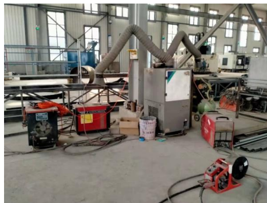
图 4-3 焊接工序治理设施
