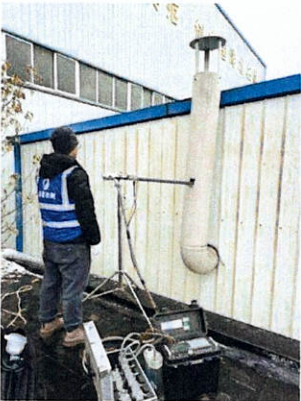
有组织废气 硫酸雾吸收塔排放口 (◎)
