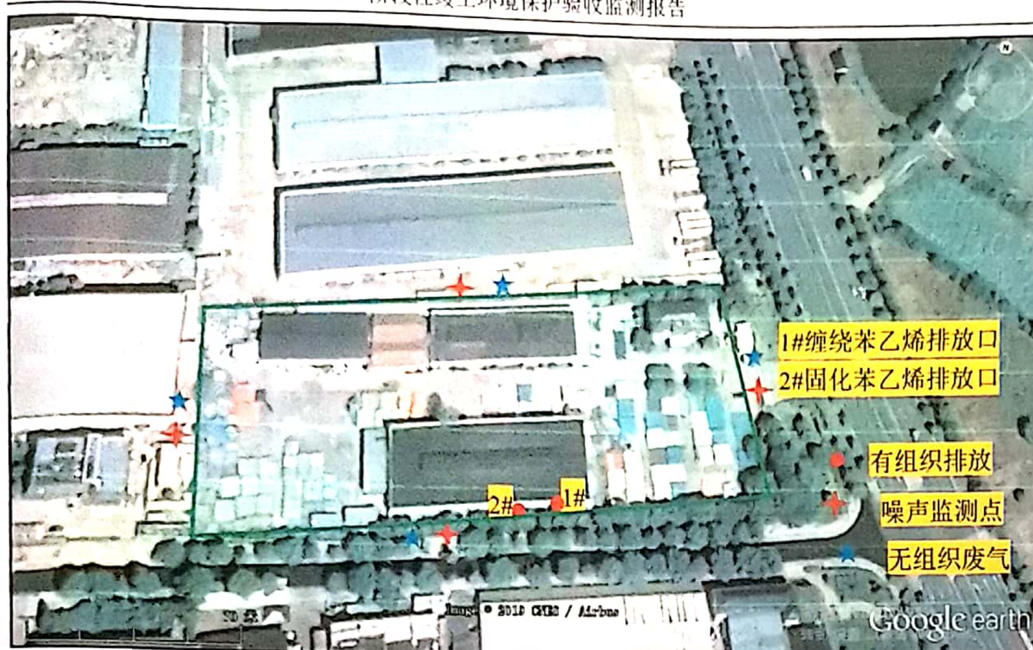
图 7-1 各污染物验收监测布点示意图
