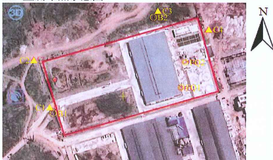
图1 有组织废气、无组织废气和厂界噪声监测布点示意图
