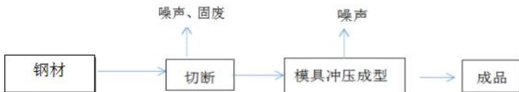
图 2-5 托盘生产工艺流程图
