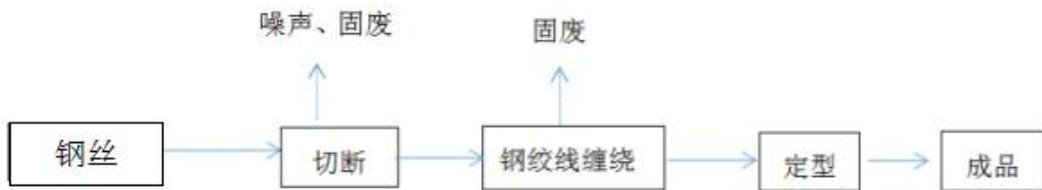
图 2-3 锚索生产工艺流程图
