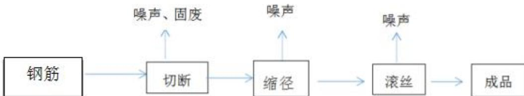
图 2-4 锚杆生产工艺流程图
