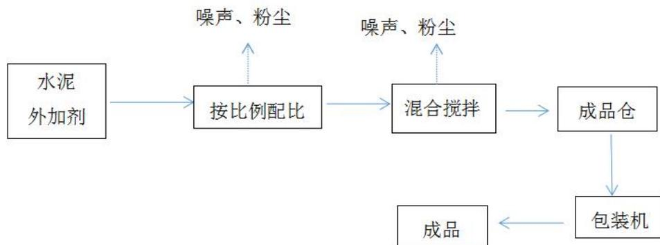
图 2-7 加固材料生产工艺流程图
