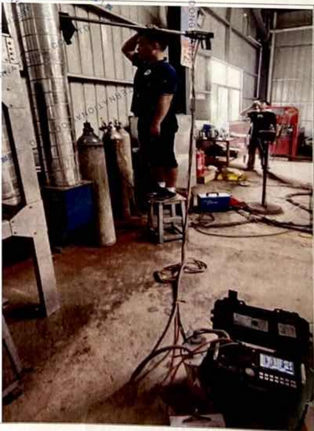
图 2: 焊接工序出口采样图
