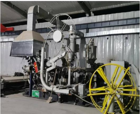
4#生产车间高密度聚乙烯结构壁管挤出机集气罩
