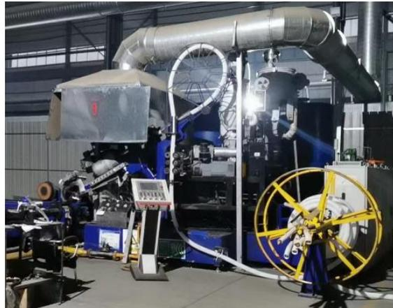
3#生产车间高密度聚乙烯结构壁管挤出机集气罩
