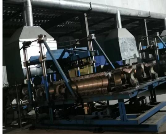
2#生产车间高密度聚乙烯结构壁管挤出机集气罩
